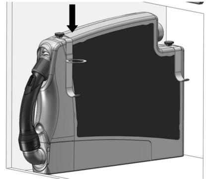
7. Schliessen Sie die Saugleitung mit einem 90° Bogen kurz (Art. 124100) an der Wuusch-Box an
