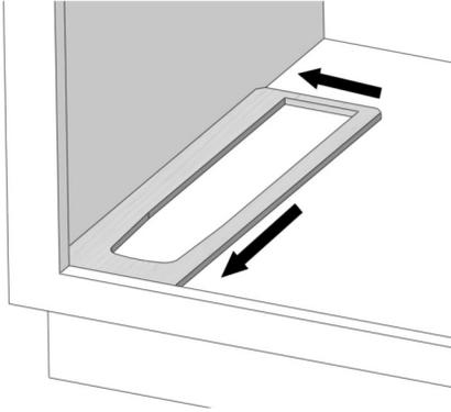
2. Halterung mit Hilfe der Karton-Schablone, mit den dafür vorgesehenen Schrauben am Boden befestigen
