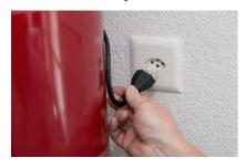
Zentralstaubsauger vom Netzstecker trennen und wieder anschliessen. Sie haben jetzt fünf Minuten Zeit, um den Schlauch anzumelden.
