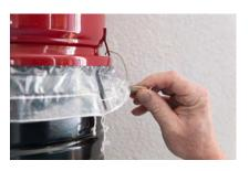
8. Klappen Sie die Verschlüsse gemeinsam langsam nach unten. Der Schmutzbehälter wird dicht unter das Gehäuse gespannt. Achten Sie auf einen einwandfreien Dichtsitz.
