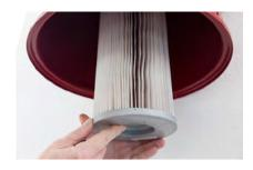
5. Nach vollständigem Lufttrocknen den Filter wieder einsetzen. Schieben Sie den Filter über den Filterhalter und ziehen Sie die Verschraubung fest an.
