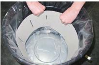
6. Jedem Staubsack ist ein Karton beigefügt. Legen Sie den Karton wie abgebildet in den Staubsack. Achten Sie darauf, dass der Staubsack dicht an der Schmutzbehälterwand anliegt.
