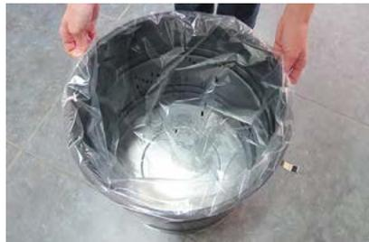
5. Legen Sie einen neuen Staubsack in den Schmutzbehälter. Ziehen Sie den Verschluss des Staubsackes so weit über den Rand des Schmutzbehälters, bis der Staubsack aussen 2 Zentimeter überhängt. Die Zugbänder sollen genau nach vorne zeigen. Ziehen Sie vorsichtig an den Bändern, bis der Aussenrand des Staubsackes eng am Schmutzbehälter anliegt.
