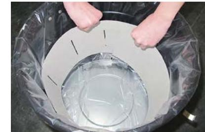
6. Jedem Staubsack ist ein Karton beigelegt. Legen Sie den Karton wie abgebildet in den Staubsack. Achten Sie darauf, dass der Staubsack dicht an der Schmutzbehälterwand anliegt.
