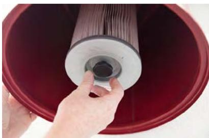
2. Lösen Sie die Verschraubung und ziehen den Filter vom Filterhalter.
