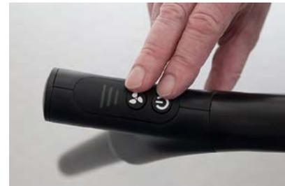
Drücken Sie den **Ein/Aus-Schalter** am Handgriff gleichzeitig mit der **PowerControl-Taste** und drücken Sie die zwei Tasten gleichzeitig so lange, bis das Gerät sich einschaltet.
