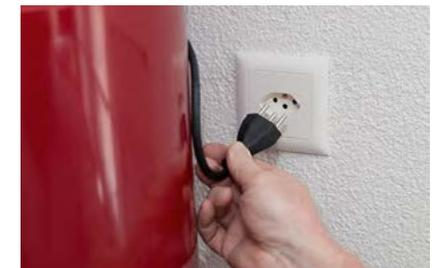
10. Den Netzstecker wieder einstecken. Beim **profivac IntelligentSystem** muss danach der Reset-Knopf am Gerät für mindestens fünf Sekunden gedrückt werden, um die Wartungsanzeigen zu löschen. Ihr Gerät ist nun wieder betriebsbereit.
