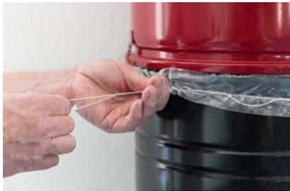
2. Zwischen Behälter und Gehäuse befindet sich ein 2 Zentimeter hoher Spalt. Ziehen Sie langsam an den Bändern des Sackes. Die Bänder verschliessen dadurch den Staubsack.
