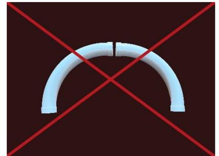
Damit sich der Saugschlauch auch leicht herausziehen lässt, darf die Zusatzschleife niemals über mehr als eine Etage geführt werden.
